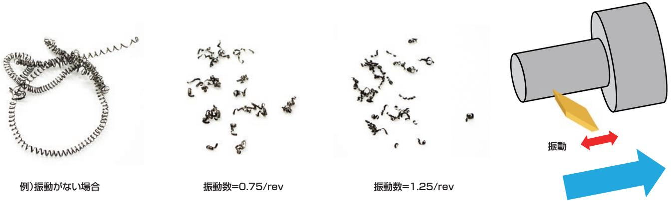
振動切削の課題：一般的な切削加工と比較し、加工中に振動が生じることによる刃先負荷や性質上加工硬化を起こした部位への衝撃によって、刃先に欠損(チッピング)が生じやすい。
