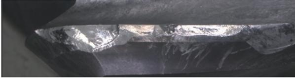
6溝加工後欠損
