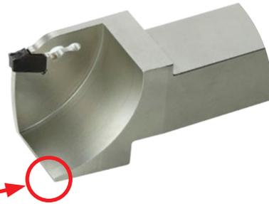
この部分が干渉するため被削材直径により最大溝入れ深さが制限されます。
