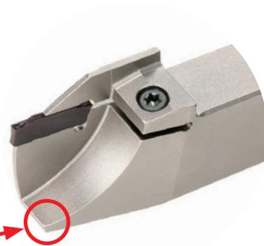
この部分が干渉するため被削材直径により最大溝入れ深さが制限されます。
