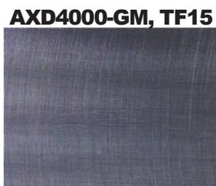
Ra 0.120μm Rz 1.132μm
