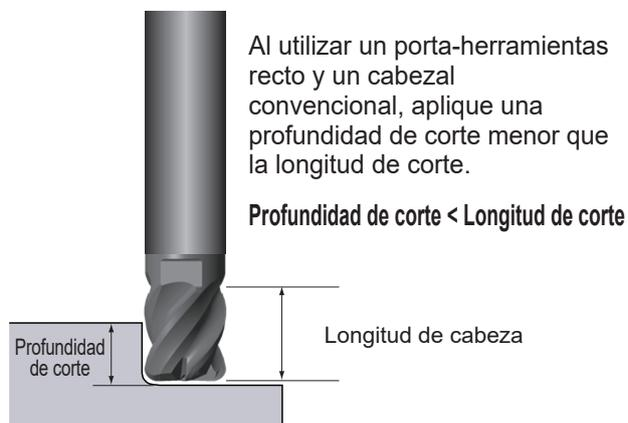
Con una profundidad de corte < que la longitud de corte, se recomienda un voladizo inferior a  $DC \times 3$ .
