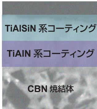
耐溶着性を向上させ、コーティング剥離を防止、耐摩耗性、耐チップング性と付着強度を向上。
