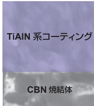
耐溶着性を向上させ、コーティング剥離を防止、耐剥離性と付着強度を向上させ、下層部は焼結体との密着力を高めた構造。
