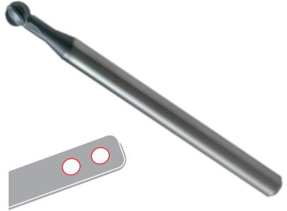
280°のワイドな切れ刃と独自の曲線切れ刃および最適なすくい面形状を採用し、アンダカットや内曲面形状などの加工に最適。
