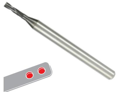
新溝設計およびZシンニング形状により、切りくず排出スペースを拡大し、低スラストを実現。傾斜面や曲面での下穴加工にも最適。
