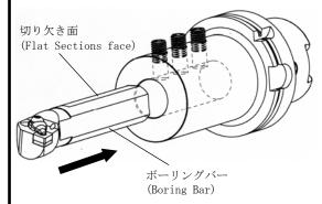
②工具シャンク切り欠き部と 締付けセットボルトの位置を 合わせ、本体に工具を挿入し ます。
