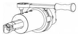
③締付けセットボルトを適正な トルクで締付けます。
