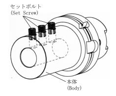
①締付け台等に本体を固定し、 セットボルトを緩めます。
