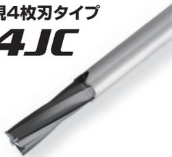
弱ねじれ角の切れ刃形状により、スラスト方向への切削抵抗が低く抑えられるため、バリやデラミネーションの発生が少ない、良好な仕上げ面が得られます。
