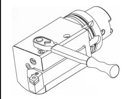
③角シャンクを本体取付け面に 押さえつけながら、セット ボルトを適正なトルクで締付 けます。
