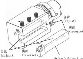
②角シャンクの背面側と端面側を 本体取付け面に合致させるよう 挿入します。
