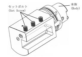
①締付け台等に本体を固定し、 セットボルトを緩めます。
