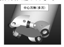
インサート同士が接触しないようにして下さい。心下がりに設計されているので、横からスライドさせるようにすれば接触しません。
