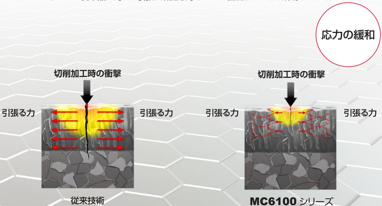
従来品は切削加工時の衝撃が集中しやすく、引張り応力の影響で、コーティング層の奥まで亀裂が浸透し欠損の原因となります。
