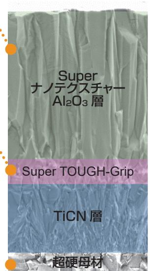
超硬母材は高硬度超硬母材を採用
