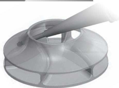
带冷却孔4刃大球头型刀头
