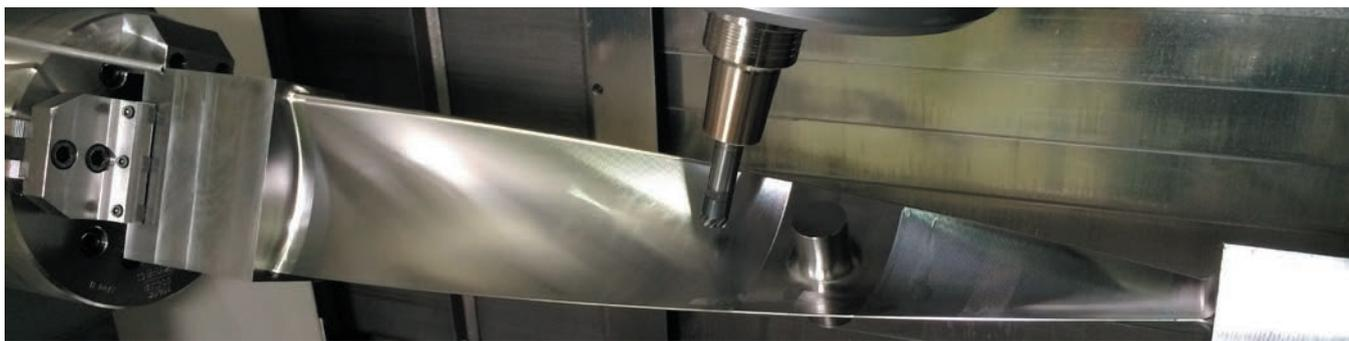
可实现与以往的叶片精加工用整体式锥形圆弧头立铣刀同等水平的加工，因而刀具费用可降低。
